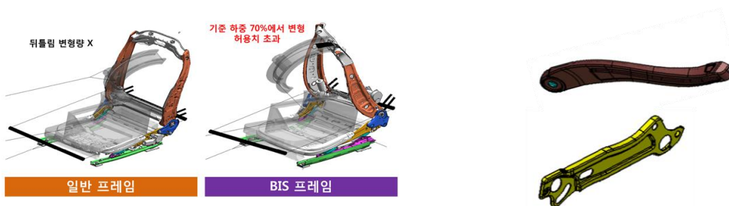
그림 1 기존 시트 프레임과 BIS 프레임 비교 그림 2 백사이드멤버 및 베이스 플레이트 형상
